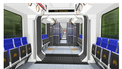
Wagenübergang mit Fahrradabteil und Klappsitzen. Mit der anschließenden Schiebetür kann ein Zugteil abgeriegelt werden, z. B. bei Verschmutzung eines Halbzuges. Der Wagenübergang beim 481er ist mit glatter Fläche besser gelöst als der Faltenbalg hier. (Zeichnung: Stadler Pankow GmbH / design: büro+staubach berlin)
