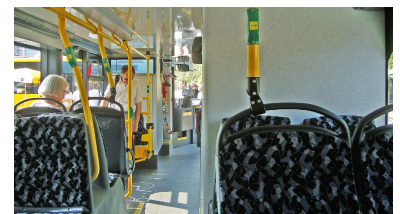
Citea: Hinter der Mitteltreppe entsteht ein wenig einsichtiger Bereich mit »Lounge-Atmosphäre«, der für Vandalismus und Verschmutzung anfällig sein könnte. (Foto: Florian Müller)
