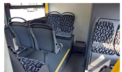
Citea: Der »Lounge-Bereich« hinter der Mitteltreppe. Der Motor und Technik im Heck-Unterdeck erlauben kein Rückfenster.
