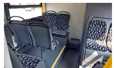
Citea: Der »Lounge-Bereich« hinter der Mitteltreppe. Der Motor und Technik im Heck-Unterdeck erlauben kein Rückfenster.
