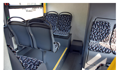
Citea: Der »Lounge-Bereich« hinter der Mittelstufe. Der Motor und Technik im Heck-Unterdeck erlauben kein Rückfenster.
