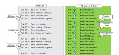
Die Express-S-Bahn bietet deutlich mehr Abfahrten, Taktlücken können geschlossen und ungerade Takte vermieden werden. Beispiel: Abfahrten ab Falkensee nach Berlin (6 bis 9 Uhr). (Grafik: S-Bahn Berlin GmbH, Daten nach Fahrplan 2016 und Express-S-Bahn vorläufiger Fahrplanentwurf)
