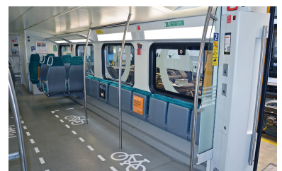
Mehrzweckabteil RE 2 und RE 4 mit ausgebauten Sitzen und Bodenmarkierung. (Foto: ODEG)
