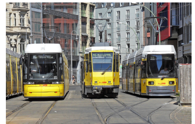
Die neuen 40-Meter-Flexity (links) lösen die ebenfalls 40 Meter langen Tatra-Doppeltraktionen (mitte) ab. Der Solo-GT6 (rechts) ist mit 30 Metern für viele Linien zu klein. Als 60-Meter-Doppeltraktion bietet er aber die richtige Größe für die M 4 und M 6. (Foto: Tom Gerlich)
