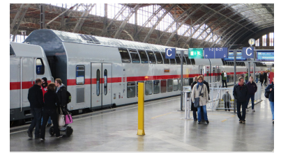
IC mit den neuen Doppelstockwagen (IC 2) in Leipzig Hbf. Getrübt wird die Freude an den neuen Zügen allerdings durch ein unangenehmes Wanken auf einigen Streckenabschnitten. Zwischen Halle (Saale) Hbf und Leipzig-Mockau wurde die Höchstgeschwindigkeit deshalb sogar auf 120 km/h herabgesetzt. Das erfordert nun fahrzeugseitig technische Nachbesserungen und sorgt damit für erneute Verzögerungen beim Einsatz. (Foto: Christian Schultz)
