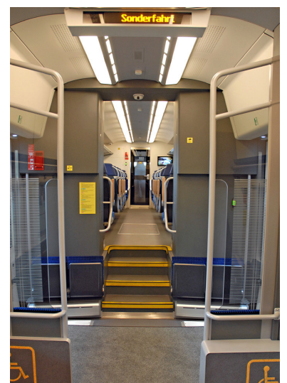
Blick vom Mehrzweck-/Rollstuhlbereich in den Eingangsraum mit Klappsitzen und in den Hochflur-Sitzplatzbereich über dem Enddrehgestell. Im Durchgang eine Videokamera und eine Fahrgastinformationsanzeige. (Foto: Marc Heller)
