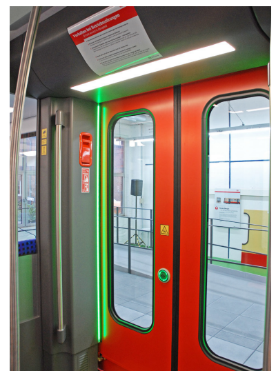
Der Türraum ist mit LED-Leisten ausgestattet, die bei freigegebener Tür grün und bei sich schließender Tür rot leuchten. (Foto: Marc Heller)
