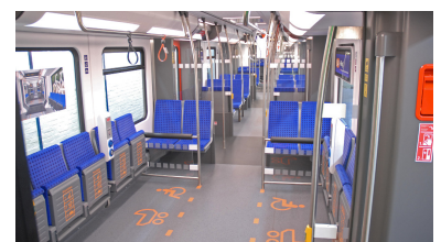
Das Mehrzweckabteil, immer hinterm Führerstand, ist mit großen Symbolen für die vorgesehene Nutzung ausgestattet, hat zwei Sprechstellen für Rollstuhlfahrer und Klappsitze. (Foto: Holger Mertens)
