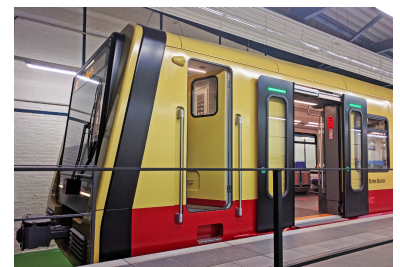
Eine eigenwillige Front zieht das Modell. Auffällig die klassische »Lok-Tür« mit zwei Griffen und Trittbrett, die zum illegalen S-Bahn-Surfen einladen könnten. (Foto: Holger Mertens)
