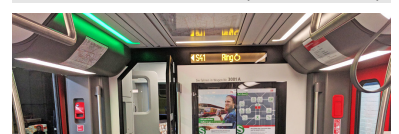
Der Türraum ist mit LED-Leisten ausgestattet, die bei freigegebener Tür grün und bei sich schließender Tür rot leuchten. (Foto: Marc Heller)
