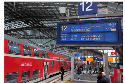
Was bei der Berliner S-Bahn schon länger geht, kann jetzt auch der Regio- und Fernzug-Anzeiger der Bahn: Folgezüge anzeigen. Die Ansicht ist noch nicht optimal. Denn erst, wenn die Gleisnummern überall auf statische Schilder umgezogen sind, wie hier am Berliner Hauptbahnhof, wird der Platz in den Anzeigen frei, um Abfahrtszeiten und Linien-/Zugnummern auch bei der ersten Abfahrt an vorderer Stelle anzuzeigen. (Foto: Holger Mertens)
