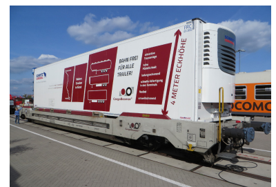
CargoBeamer: Diese Variante des Kombinierten Verkehrs ermöglicht eine schnelle Bahnverladung speziell auch der seitens des Transportgewerbes (leider) überwiegend eingesetzten nicht kranbaren Sattelaufleger. Technische Lösungen für eine umfassende Verlagerung von Transporten auf die Schiene sind damit vorhanden! (Foto: Christian Schultz)
