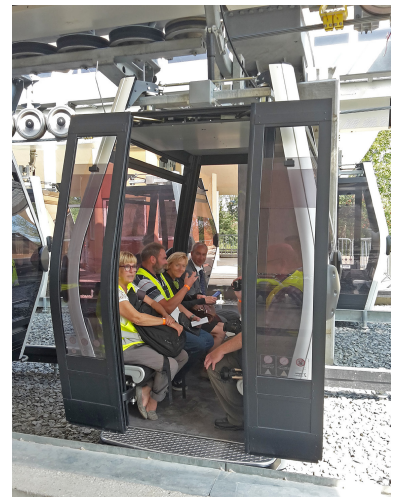
In einer Kabine finden 8 Personen Platz, der Einstieg ist stufenlos (auf dem Bild ist der Bahnsteig-Fußboden noch nicht fertig gestellt). Die Kabine kann auf Wunsch kurz zum Stillstand gebracht werden, so dass auch Mobilitätseingeschränkte und Rollstuhlfahrer einsteigen bzw. einfahren können. (Foto: Florian Müller)
