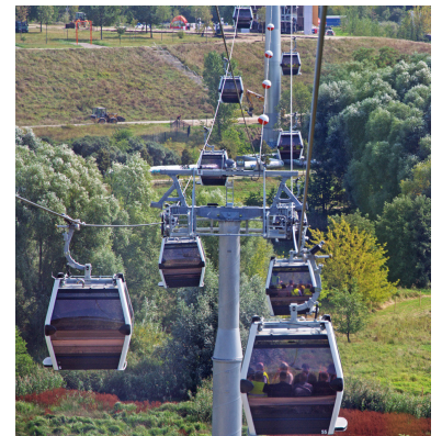
Die Umlaufseilbahn ist durch ihre kontinuierliche Abfahrt attraktiv, siehe Abb auf Seite 7. (Foto: Michael Dittrich)
