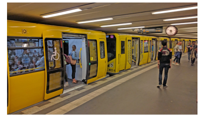
Positiv! Auch im Fahrgasteinsatz lassen sich die beiden Kleinprofil-Baureihen HK (links) und IK (rechts) kuppeln und ermöglichen einen flexiblen Einsatz. Aber da nur Fachleute sie unterscheiden können, ist die unterschiedliche Anordnung der Abteile für Rollstühle und Fahränder ein Problem. (Foto: Holger Mertens)
