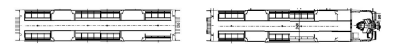
Prinzip-Skizze der geplanten Baureihe JK. Um einen weiteren Sitzplatzverlust zu vermeiden, werden im Kleinprofil die schon früher einmal üblichen zwei Türen pro Wagenseite verwendet. Die BVG ist zuversichtlich, dass es zu keinen Fahrgast-Staus kommt. (Grafik: BVG)
