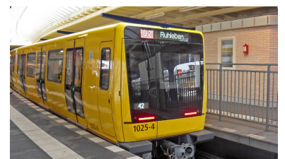
Die Baureihe IK mit den »bombierten« (ausgewölbten) Seitenwänden, die auch beim Nachfolger JK verwendet werden. (Foto: Tom Gerlich)
