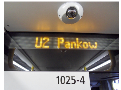
Der klassische Innenanzeiger an den Wagenenden und -übergängen ist noch immer die sinnvollste Anzeige und neben der Ansage die wichtigste Informationsquelle für die nächste Station. Darüber eine der vielen Überwachungskameras. Der Datenschutz ist durch das planmäßige Löschen nach 72 Stunden schon im Fahrzeug berücksichtigt. (Foto: Tom Gerlich)
