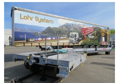
Das LOHR-System ist eines der Umschlagsysteme des Kombinierten Verkehrs, das es ermöglicht, auch die vielen nicht-kranbaren Sattelaufleger auf die Schiene zu bringen und so zum Ausbau der Elektromobilität beizutragen. Es fehlt jedoch am politischen Willen zum forcierten Ausbau der notwendigen Verlagerungsinfrastruktur. (Foto: Christian Schultz)
