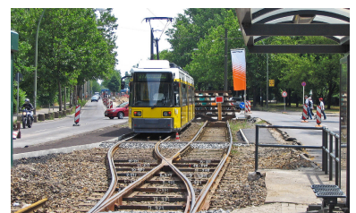
Niederflurfahrzeug der ersten Generation. Als Doppeltraktion mit 55 Metern Länge nutzen sie die Haltestellenlänge fast optimal aus. Die Zweirichtungsversion ermöglicht eine flexiblere Betriebsführung bei Baustellen und Störungen. Auch der Nachfolger der dritten Generation muss diese Mindestanforderung erfüllen. (Foto: Tom Gerlich)
