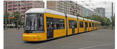
Fotomontage: So könnte eine 11-teilige 60 Meter lange Straßenbahn aussehen. Die IGEB fordert, bei der dritten Niederflergeneration der BVG nicht nur 50, sondern 60 Meter lange Züge zu bestellen, denn mit der vollen Ausnutzung der Haltestellenlänge stehen Kapazitätsreserven zur Verfügung, die aufgrund der wachsenden Fahrgastzahlen künftig genutzt werden müssen. (Foto/Montage: Raul Stoll)
