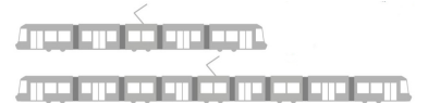
Die geplanten zwei Zuggrößen von 30 Meter und 50 Meter Länge. Eine mögliche spätere Verlängerung der kurzen Züge wird von der BVG erhofft, aber die kurze Beschaffungsdauer der elektronischen Komponenten spricht leider dagegen. Auch die Verlängerung der XLZ-Wagen auf 60 Meter könnte daran scheitern - deshalb lieber gleich großzügig beschaffen! (Grafik: Holger Mertens)
