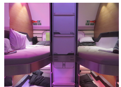
Das Liegewagenkonzept mit Mini-Suiten wurde vom Designbüro Studio SYN entwickelt. Anstelle der bislang üblichen Vierer- bzw. Sechserabteile sind die Kojen bei diesem Designentwurf einzeln abschließbar. Damit wird dem häufig geäußerten Wunsch von Reisenden nach einer höheren Privatsphäre Rechnung getragen. (Foto: Christian Schultz)
