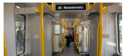
Blick durch den Innenraum. Positiv fällt die Vielzahl der optischen Informationsmöglichkeiten auf, negativ der mangelhafte Durchblick durch die quer eingebauten Bildschirme - aber das ist beim Kleinprofilfahrzeug ein schwer lösbares Problem. (Foto: Marc Heller)
