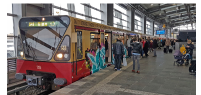
Zug der Baureihe 480. Die S-Bahn prüft, ob diese Züge nicht doch auf das Zugbeeinflussungssystem ZBS umgerüstet werden können und damit in den nächsten Jahren flexibler und vor allem über 2023 hinaus einsetzbar sind. (Foto: Marc Heller)
