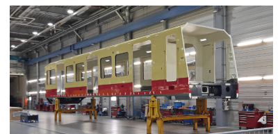
Am 14. Oktober 2017 konnte im Pankower Werk von Stadler der erste Wagenkasten für die neue Berliner S-Bahn-Baureihe 483/484 öffentlich besichtigt werden. (Foto: Florian Müller)
