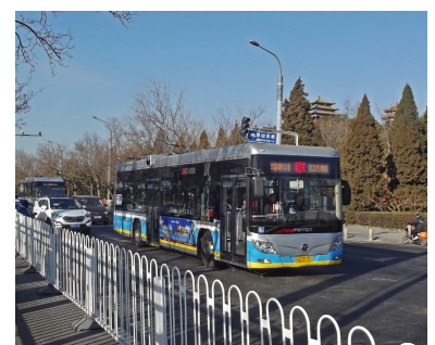
E-Bus in Shanghai (oben) und in Peking (unten). In China sind Elektrobusse schon in deutlich größerer Zahl zu finden. Dabei kommen unterschiedliche technische Konzepte zum Einsatz: Es sind sowohl reine Batteriebusse wie auch solche mit Supercap-Technologie oder Hybrid-Fahrzeuge zu finden, die die vorhandenen Obus-Fahrleitungen zur Zwischenladung nutzen. Dieses Konzept wird in Deutschland gerade in Esslingen erprobt. (Foto: Martin Schiefelbusch (Dezember 2017))
