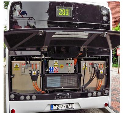
Blick in die Motorraum des Solaris. Zu sehen sind eigentlich nur die beiden Traktionsbatterien (links und rechts) und ein wenig Elektronik. Die restliche Elektronik der Firma Vossloh Kiepe wurde wegen des großen Platzbedarfs der Traktionsbatterien auf dem Dach untergebracht. (Foto: Pawel Misiak)
