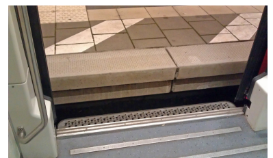
Fürstenwalde (Spree). Auch die Ein- bzw. Ausstiegsverhältnisse bei Doppelstockwagen sind an Bahnsteigen mit 0,76 Metern unbefriedigend und behindern zudem in unnötiger Weise den Fahrgastwechsel. (Foto: IGEB)
