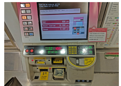
Bargeld ist weiterhin Trumpf in Japan - ähnlich wie in Deutschland. Daher nehmen hier alle Ticketautomaten uneingeschränkt jede Bargeldnote und geben auch Noten als Wechselgeld, wie hier zu sehen. Selbstverständlich immer in der für den Kunden sinnvollsten Stückelung. (Foto: Holger Mertens)
