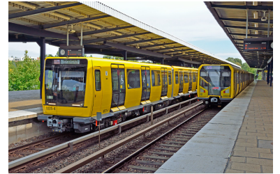
Im Bahnhof Wuhletal begegnen sich ein IK17 mit den Anbauten (links) und ein H-Zug (rechts). Deutlich ist die unterschiedliche Wagenkastenbreite zu erkennen. Wegen der geringeren Wagenbreite werden die IK17 im Großprofilnetz als eng empfunden. (Foto: Michael Dittrich)
