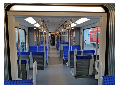
Großzügiger Raumeindruck, obwohl mehr Haltestangen eingebaut wurden. Zwischen Dach und Fenster passen gerade so die Klimaanlage, ebenfalls eine Neuheit bei der S-Bahn Berlin. (Foto: Florian Müller)
