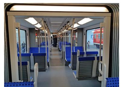
Großzügiger Raumeindruck, obwohl mehr Haltestangen eingebaut wurden. Zwischen Dach und Fenster passen gerade so die Klimaanlage, ebenfalls eine Neuheit bei der S-Bahn Berlin. (Foto: Florian Müller)
