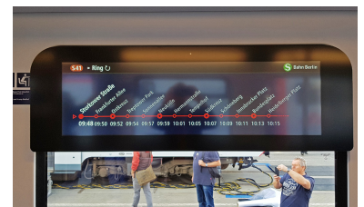
Erstmals in Serie in Berlin: Linien- und Zielanzeigen in den Seitenscheiben der neuen S-Bahn-Baureihe. Die Darstellungsarten können im Wechselmodus gezeigt werden und sowohl die farbigen Linien-signets als auch die Perlschnur für wesentlich mehr als nur die nächsten 3 Stationen sind ein Gewinn für die Fahrgäste. (Foto: Florian Müller)
