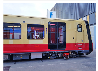
Nicht auf den ersten Blick sichtbar: die zahlreichen Kameras am und im Zug. Auf dem Bild aber gut erkennbar: die Leuchtstreifen an den Türen, die schon von weitem signalisieren, ob noch freigeschaltet ist. (Foto: Florian Müller)
