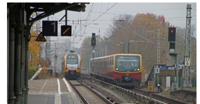
Da nur ein Gleis von der südlichen Bahnhofseinfahrt bis über den Nottekanal hinaus für den gesamten Durchgangsverkehr zur Verfügung steht, ist öfters »Warten« angesagt, so wie hier die RB 22 (Frontlichter links zwischen den Masten) auf den verspäteten RE 2 wartet, der von einem vor ihm fahrenden Güterzug ausgebremst wurde. (Foto: BfVst)
