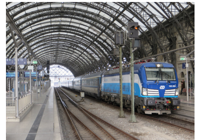
Mehrsystem-Elektroloks vom Typ VECTRON MS werden bereits durchgehend vor den Eurocity-Zügen der Relation Hamburg--Berlin--Prag eingesetzt, hier in Dresden Hauptbahnhof. Auch für die Bahnstromsysteme Deutschlands und der Niederlande ist eine entsprechende Variante bereits zugelassen. (Foto: Christian Schultz)
