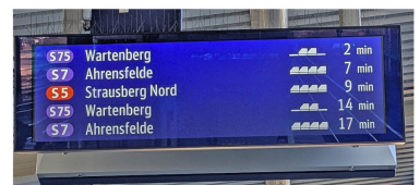
Die seit zwei Jahren ausgerollten ZIM Anzeiger: Höhere Bauform, aber bei Sonneneinstrahlung nicht gut lesbar und bereits mit Ausfallerscheinungen. Die Auslastungsanzeige »Lightgate« funktioniert recht zuverlässig. (hier S-Bf Friedrichstraße und S-Bf Lichtenberg) (Fotos: Florian Müller)
