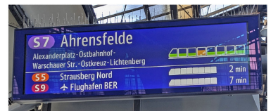
Auf den Bahnsteigen der S-Bahn werden nach und nach neue LED Anzeiger aufgehängt. flacher und pixeliger, aber leuchtstärker. Durch die flachere Bauform werden nur noch zwei statt drei (im Einfahrmodus, oben) bzw. vier statt fünf Züge (unten) angekündigt. (hier S-Bf Nöldnerplatz) (Fotos: Florian Müller)
