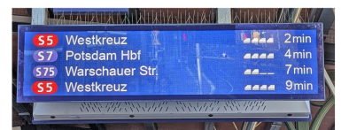
Auf den Bahnsteigen der S-Bahn werden nach und nach neue LED Anzeiger aufgehängt. flacher und pixeliger, aber leuchtstärker. Durch die flachere Bauform werden nur noch zwei statt drei (im Einfahrmodus, oben) bzw. vier statt fünf Züge (unten) angekündigt. (hier S-Bf Nöldnerplatz) (Fotos: Florian Müller)
